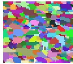
EBSD 4 -Bild des mit dieser Technologie erzeugten Platinwerkstoffs
