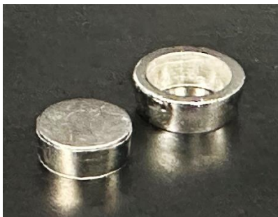
Mit dieser Technologie erzeugter Platinwerkstoff (zylindrisch und ringförmig)
